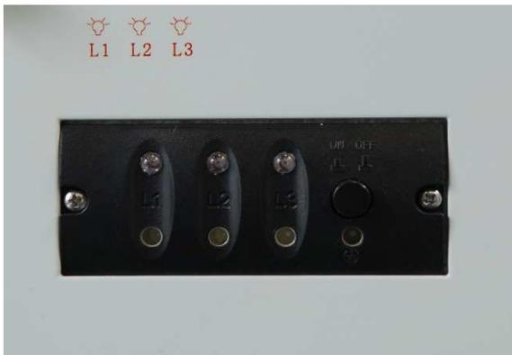
Устройство предназначено для визуального контроля наличия или отсутствия рабочего напряжения на кабеле, независимо в каждой из фаз.
